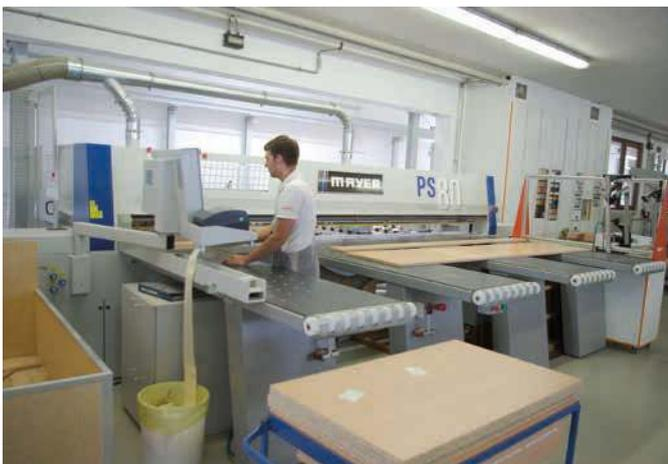
für Reste, Sonder- und bestimmte Standardformate gibt es dafür auch acht Stapelplätze für 2 800 x 2 100 mm große Platten. Diese acht Plätze sind chaotisch ausgelegt, sodass sich die unterschiedlichen Platten schnell einlagern und entnehmen sowie die Fahrwege des bis zu 120 m/min schnellen Saugwagens optimieren lassen.
