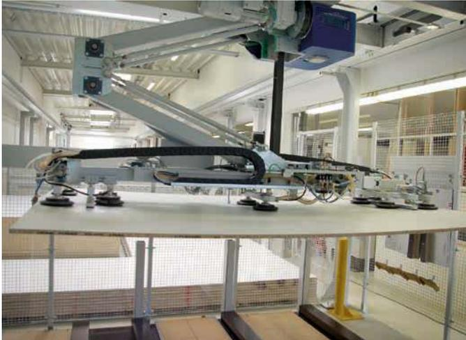
▲ Durch Verfahrensgeschwindigkeiten bis 120 m/min sorgt der Saugwagen des Flächenlagers für ein schnelles Einlagern und Entnehmen von Platten
